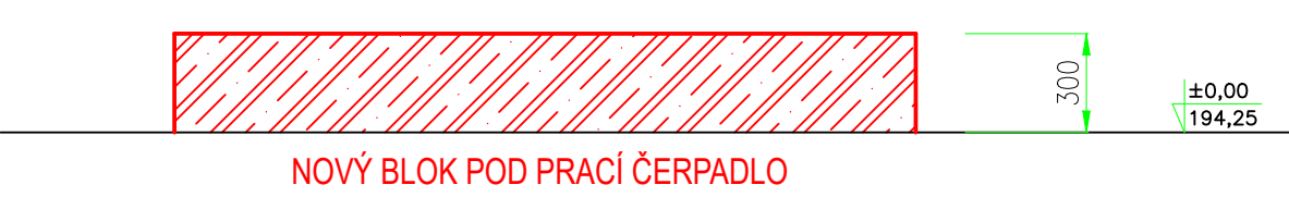
VÝPIS ZÁKLADOVÝCH BLOKŮ POD TECHNOLOGICKÁ ZAŘÍZENÍ - BETON C 25/30
